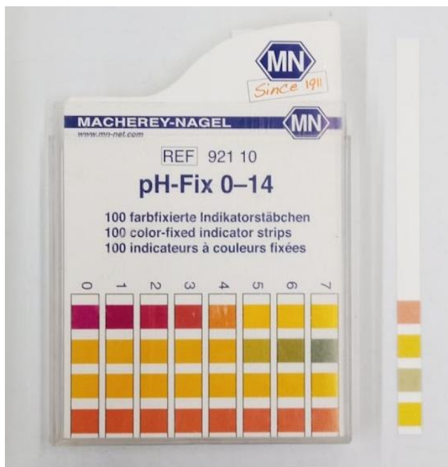
Fig.2.4 Tiras reactivas para medición de pH, Macherey-Nagel pH-Fix 0-14
