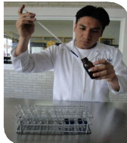
Fig. 1.7 Agregar con una pipeta 0.5 mL de solución de azul de metileno
